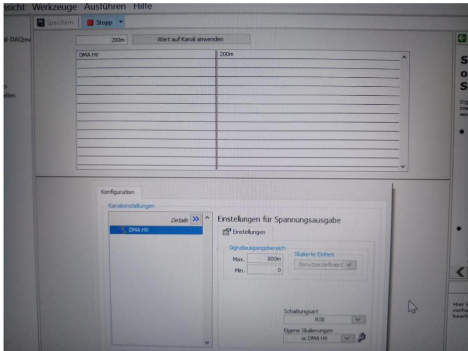
7. Put 0 volt in front of “wert auf kanal Anwenden” (apply) and press wert auf kanal Anwenden (apply) and Ausführen (start).
